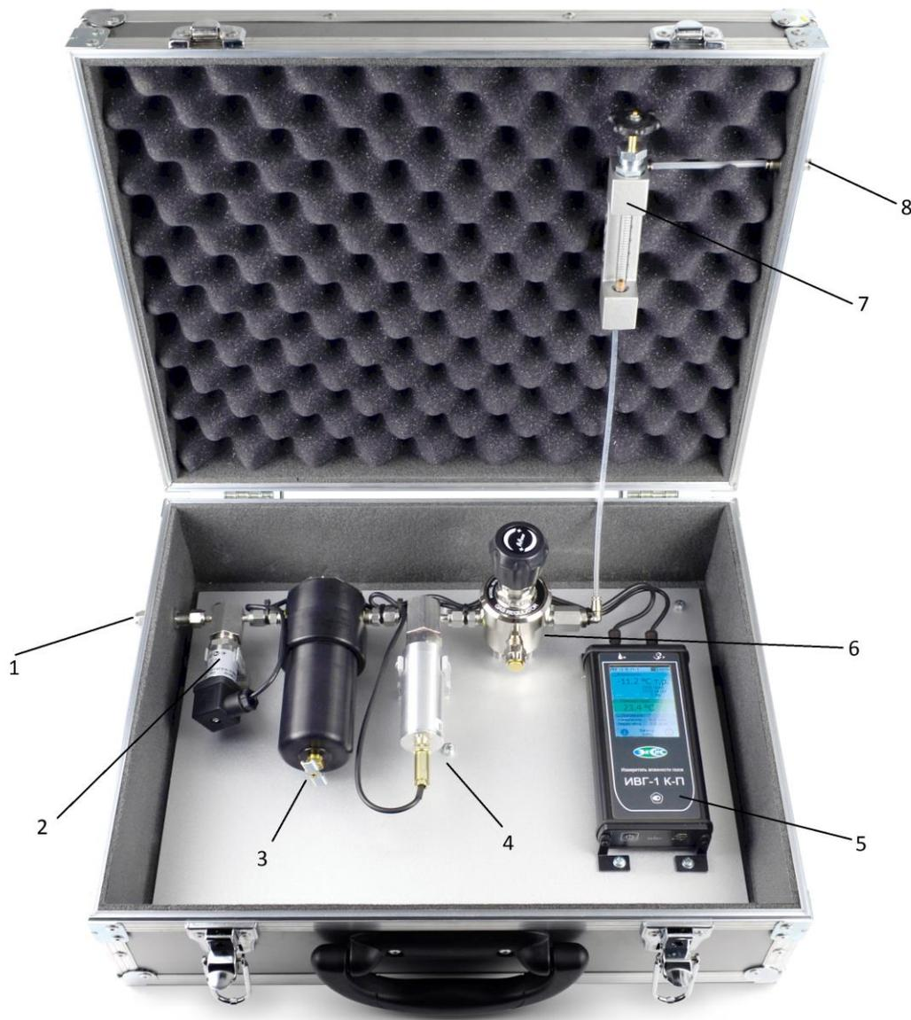
Рисунок 3.1 Внешний вид системы пробоподготовки СПГ-В-Д1-ФМ-Д-Р-М
